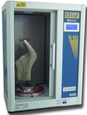
Vettorizzazione automatica delle linee di stile presenti sulla superficie di una forma
