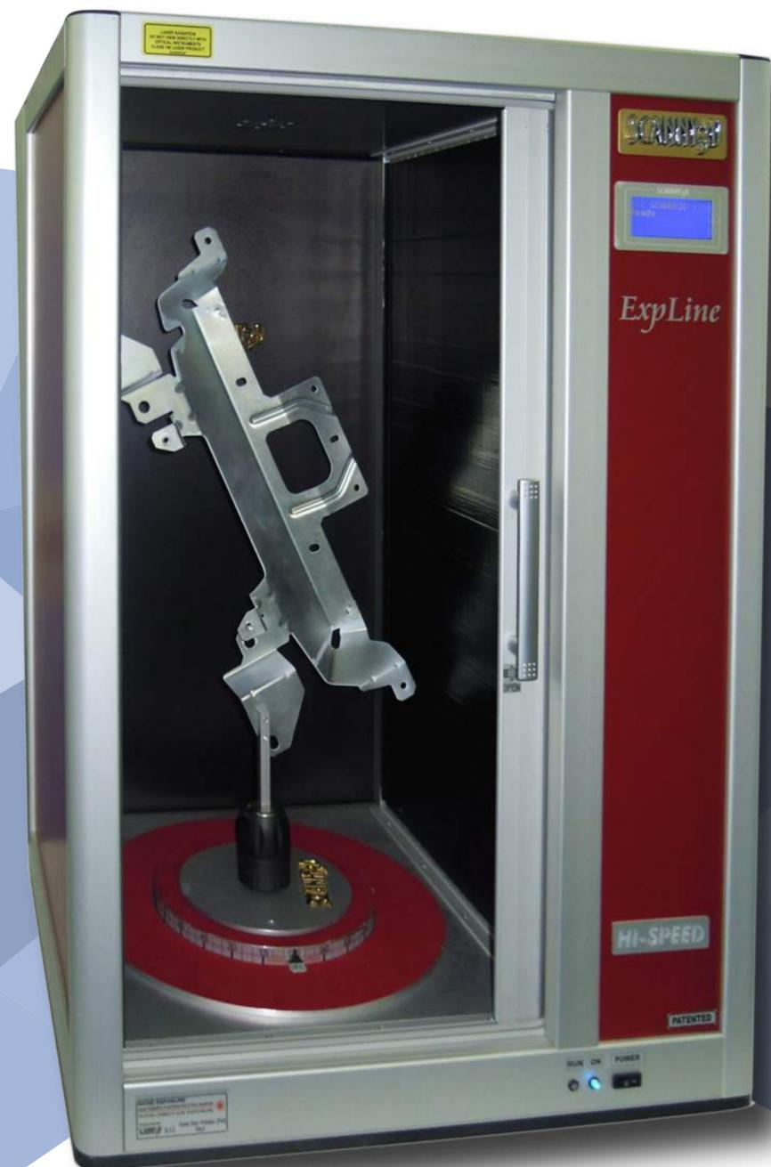
Nuovo scanner 3D a doppia lama laser ultra-veloce per una scansione senza contatto, ad elevata velocità e completamente automatica a 360° che acquisisce contemporaneamente sia la forma che i colori (opzionale) dell'oggetto e restituisce un modello 3D ad altissima risoluzione.
