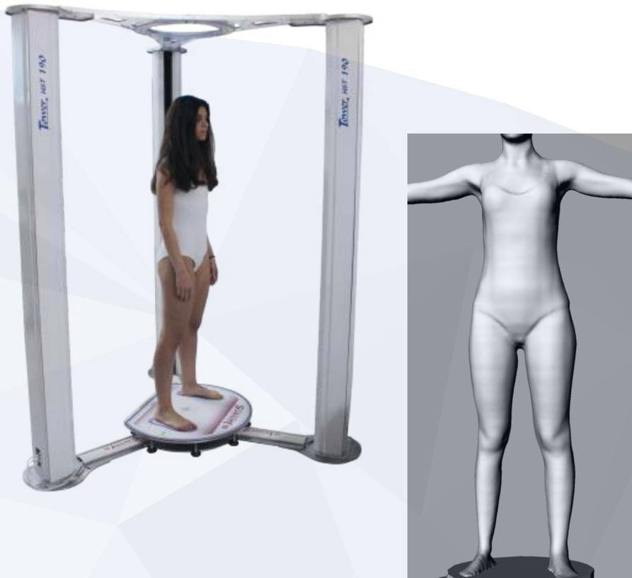
Lo strumento **SCANBODY3D** è un sistema combinato da 3 unità di scansione laser 3D (Tower) in grado di effettuare automaticamente e in pochi secondi una scansione 3D completa del corpo umano e restituire un modello 3D accurato utile ai fini della valutazione volumetrica e delle misure antropometriche delle varie parti del corpo umano.
